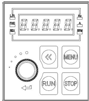
Встроенный пульт KP00 может использоваться для установки/считывания параметров, управления, мониторинга и т. д.
